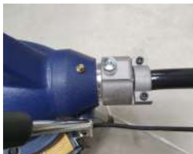
Obr. 5: Ochranná hadice upevněná přes spirálu, zajišťovací kolík je označen šipkou.
