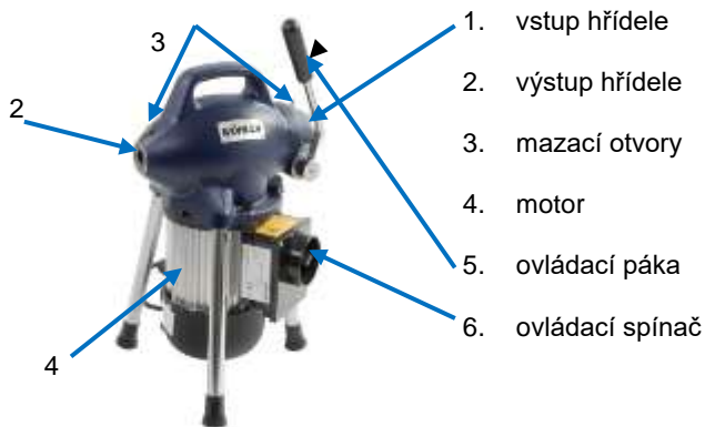
Obr. 1: Části přístroje
