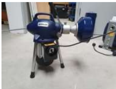
Obr. 10: Adaptér připojený k přístroji, zajišťovací kolík je označen šipkou
