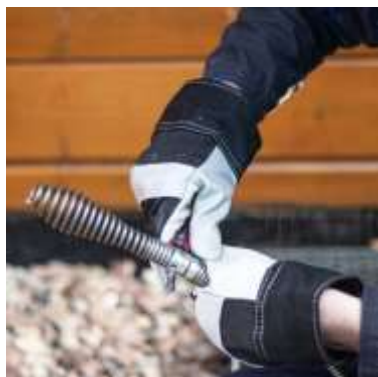
Obr. 7: Uvolněním západky oddělte vrták od spirály
